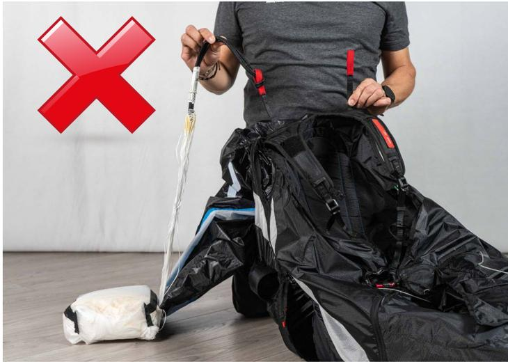
Per evitare anomali caricamenti laterali, la fune va agganciata a tutte due le asole poste sulle rispettive spalline. Non solo ad una delle due.
