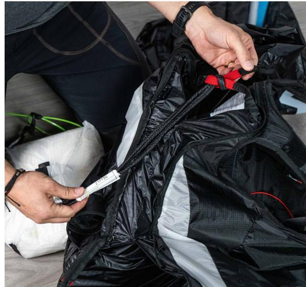
Se la vostra emergenza è dotata di fune di vincolo sdoppiata, si può connetterla all'imbragatura utilizzando le due asole delle spalline.
