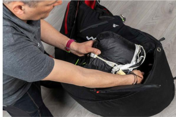
Schiebe das Reißverschlusschiffchen des Bezugs in die Endposition. Fädle das Zugseil durch die Öffnung des Reißverschlusschiffchens und stecke dann den Kunststoffstift des Griffs in die ersten beiden Schlaufen. Schließe anschließend mit dem Zugseil den Reißverschluss einige Zentimeter. Fahre fort, indem du den Splint durch die verbleibenden Schlaufen fädelt und, wie gerade getan, das Schiffchen schließt, indem du es bis an sein Fach ziehst.
