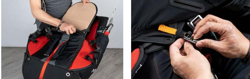
Sobald das Gurtzeug getrocknet ist, solltest du alle Metallteile sorgfältig überprüfen und schmieren, um Schäden und die Bildung von Rost zu vermeiden.
