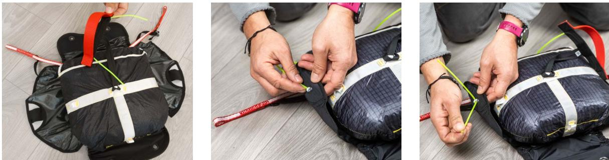
Infilare le asole elastiche attraverso gli occhielli della patella superiore e successivamente in quella inferiore, procedere fissando i pin della maniglia nelle rispettive asole elastiche alla fine togliere il cordino sottile. Assicurare la maniglia al contenitore con il velcro, in modo che mantenga la posizione ideale e si eviti un'apertura accidentale, come ultima cosa infilare i due pin nei fori posti nella patella inferiore.
