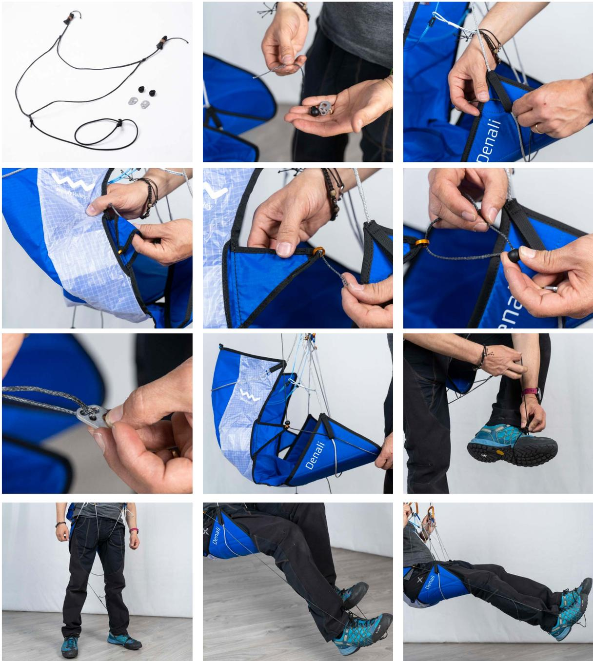
Wird der Beschleuniger nicht genutzt, empfiehlt es sich, die Seitenklappen mit dem Ring in den entsprechenden Taschen zu verschließen.
