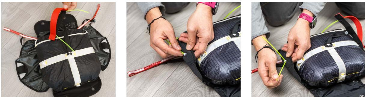
Führe die elastischen Schlaufen durch die Ösen der oberen und anschließend durch die Ösen der unteren Klappe. Befestige anschließend die Splinte des Griffs in den entsprechenden elastischen Schlaufen und entferne am Ende die dünne Schnur. Befestige den Griff mit dem Klettverschluss am Container, damit er die ideale Position beibehält und ein versehentliches
