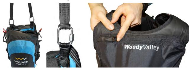
Für diese Verbindung benötigt man zwei Schraubkarabiner mit einer Bruchlast von mindestens 1400 kg. Es muss sichergestellt werden, dass die Länge der Verbindungsgurte ausreicht, um das Rettungsgerät in den dafür vorgesehenen Rettungsschirm-Container des Gurtzeugs einzufügen. Es muss genügend Gurtlänge vorhanden sein, um sicherzustellen, dass bei der Betätigung des Rettungsschirms der Rettungsschirm noch im Innen-Container bleibt, bis er geworfen wird.
