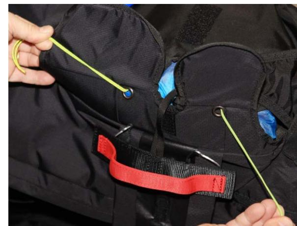
Infilare i pin metallici della maniglia nelle asole elastiche. Il cordino deve essere assolutamente tolto al termine di questa fase, va estratto lentamente per non danneggiare le asole elastiche per eccessivo sfregamento fra le parti. Alla fine la maniglia va inserita sotto la copertura. Sistemare la patella di copertura finale in modo che risulti aderente e che copra il velcro della maniglia.
