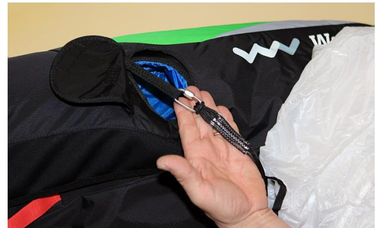
Fissare all'apice della calotta la maniglia in dotazione con un nodo a bocca di lupo. Ripiegare con cura le funi e la calotta del paracadutino rispettando le dimensioni della tasca interna. Infilate il paracadute ripiegato nella tasca lasciando uscire la maniglia che bloccherà il tutto con il velcro. Infilare la patella esterna all'interno della maniglia e successivamente all'interno della tasca contenente il paracadutino.
