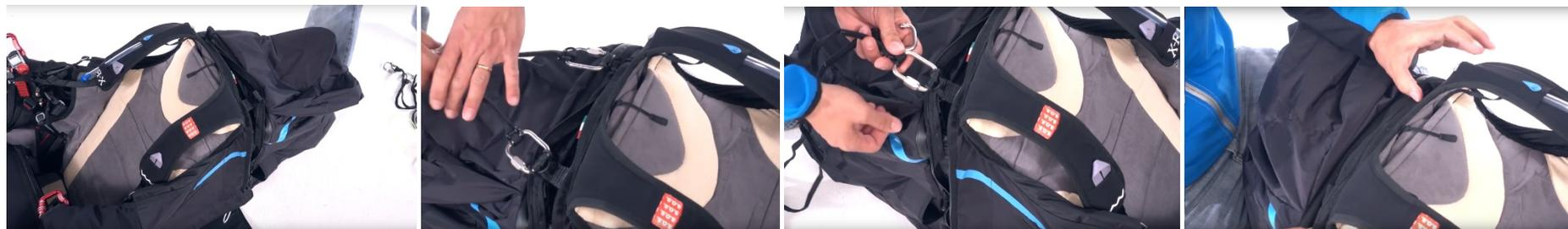
Le due connessioni vanno fatte con i moschettoni a vite con carico di rottura di almeno 1400 Kg. In ogni caso va verificato che la lunghezza della fune di vincolo sia sufficiente a posizionare l'emergenza dentro il contenitore integrato dell'imbragatura e che rimanga un lasco sufficiente a consentire l'estrazione dell'emergenza senza provocare l'apertura della sacca di lancio in fase di estrazione.
