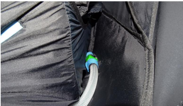
L'alloggiamento per la zavorra si trova sotto la seduta, aprire la cerniera per accedervi ed inserire il tubo di scarico nel foro di passaggio situato a destra ed installare la zavorra. Far scorrere il tubo nell'intercapedine a lato fino a farlo uscire all'esterno. Alloggiare il rubinetto nel foro e con i velcri blu fissare il tubo affinché non si muova.
