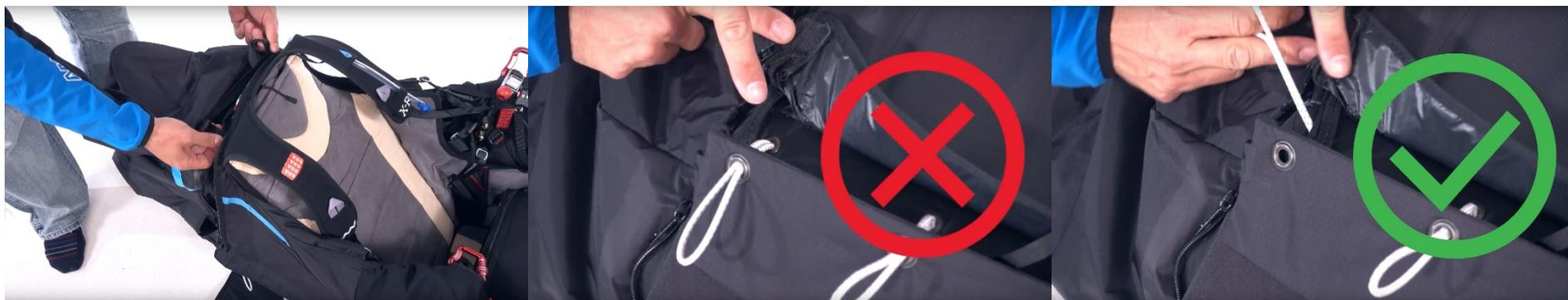
Infilare un cordino sottile (tipo fascio funicolare di parapendio) nell'asola elastica piccola, con la quale riuscirete a chiudere il contenitore successivamente.
