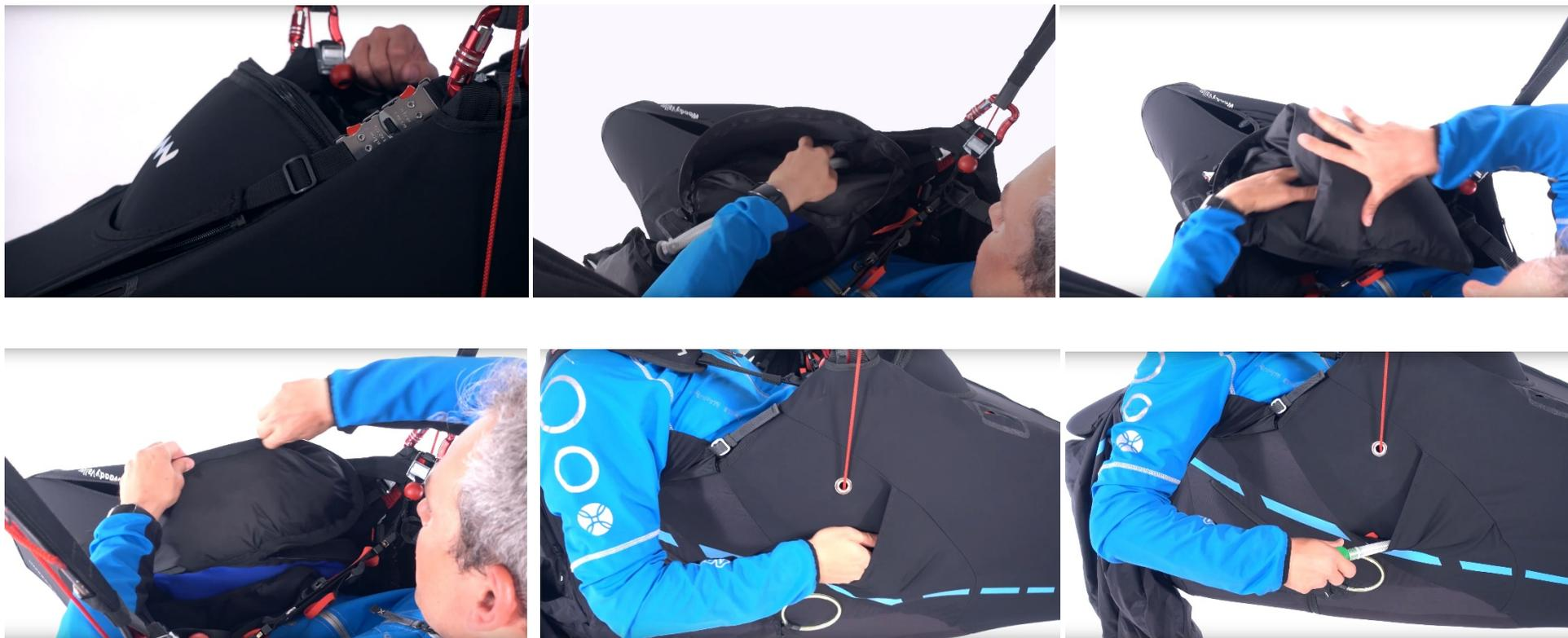
Aprire la cerniera sotto il portastrumenti per accedere all'alloggiamento della zavorra, quindi aprire il foro di uscita del tubo di scarico coperto dal velcro e far passare il tubo. All'interno dell'imbragatura si trova un secondo foro di passaggio che permette allo scarico di arrivare nella tasca esterna dove può essere nascosto ed estratto in caso di necessità.
