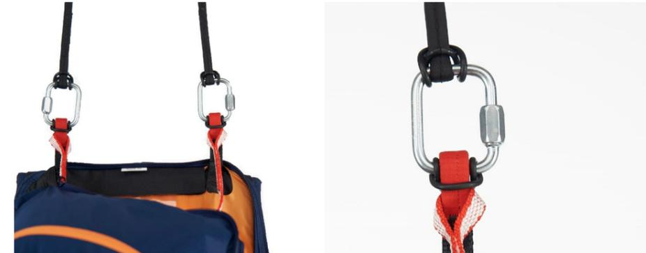
Die beiden Anschlüsse werden mit den Schraub-Karabinern mit Bruchfestigkeit von mindestens 1400 kg hergestellt. Auf alle Fälle ist zu prüfen, dass die Länge der Aufziehleine lang genug ist, um den Rettungsschirm in den eingebauten Behälter des Gurtzeugs zu verstauen und dass ein loses Stück übrig bleibt, das für das Auslösen des Rettungsschirms ausreicht, ohne dass sich beim Auslösen der Innencontainer öffnet.
