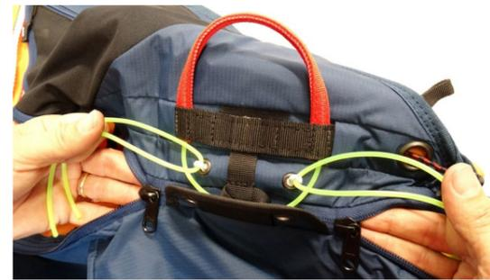
Nachdem Sie alle Teile des Containers geschlossen haben, muss überprüft werden, dass die beiden Reißverschlüsse unter dem Öffnungssystem korrekt geschlossen sind.
