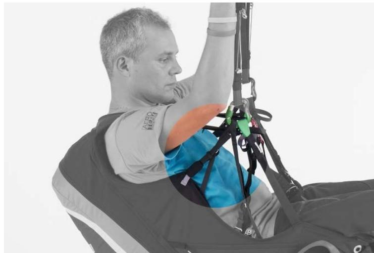
In questa foto si può notare come la regolazione della schiena lavori ripartendo il carico su due punti per ogni lato, in modo da migliorare il confort. Questa regolazione permette di scegliere l'inclinazione del busto rispetto all'asse verticale di volo.
