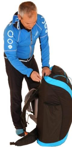
Sobald das Gurtzeug eingezogen ist, das Ganze umstülpen und den Reißverschluss verschließen. Das Heckteil nach innen falten. Das verwendete Material erlaubt jede Faltungsweise ohne Beeinträchtigung ihrer Funktion während des Flugs. Im oberen Teil bleibt genügend Raum für die Instrumente und den Helm.
