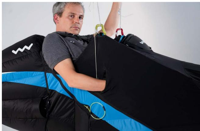
Il cordino deve essere assolutamente tolto al termine di questa fase. Fissare la maniglia che la manterrà nella posizione ideale ed eviterà aperture accidentali. Chiudere completamente la cerniera che copre la fune di vincolo. Spingendo il cursore a fine cerniera in altro a sinistra dietro le spalle.
