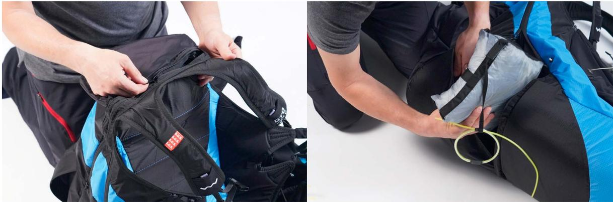
Inserire il paracadute ed il suo fascio nel contenitore dell'imbragatura mantenendo il triangolo (di connessione tra maniglia e sacca di lancio) rivolto verso l'alto ed il fascio funicolare verso la coda dell'imbrago.
