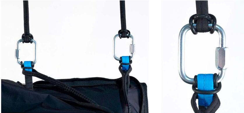
Le due connessioni vanno fatte con moschettoni a vite con carico di rottura di almeno 1400 Kg. In ogni caso va verificato che la lunghezza della fune di vincolo sia sufficiente a posizionare l'emergenza dentro il contenitore integrato dell'imbragatura e che rimanga un lasco sufficiente a consentire l'estrazione dell'emergenza senza provocare l'apertura della sacca di lancio in fase di estrazione.
