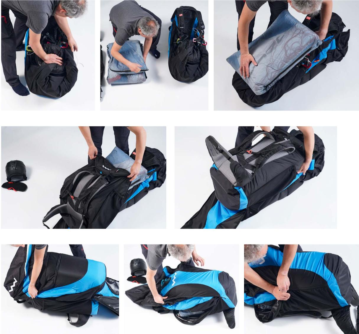
Una volta infilata l'imbragatura rovesciare il tutto e chiudere la cerniera. Ripiegare il codino all'interno, i materiali utilizzati consentono qualsiasi grado di ripiegamento senza compromettere il loro funzionamento in volo. Nella parte alta rimarrà spazio sufficiente per gli strumenti e il casco.
