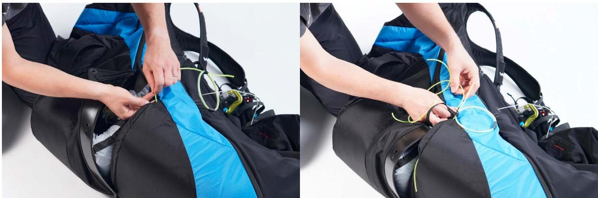
Chiudere il lembo grande in plastica nera usando il cordino e bloccare l'elastico usando il pin della maniglia più lungo, facendolo passare prima nel foro appena sotto all'inserimento maniglia poi nell'elastico e per ultimo nel foro posto dopo l'elastico. Alla fine togliere il cordino sottile.
