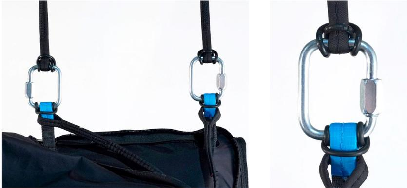
Die beiden Anschlüsse werden mit Schraub-Karabinern mit Bruchfestigkeit von mindestens 1400 kg hergestellt. Auf alle Fälle ist zu prüfen, dass die Länge der Aufziehleine lang genug ist, um den Rettungsschirm in den eingebauten Behälter des Gurtzeugs zu verstauen und dass ein loses Stück übrig bleibt, das für das Auslösen des Rettungsschirm ausreicht, ohne dass sich beim Auslösen der Innencontainer öffnet.
