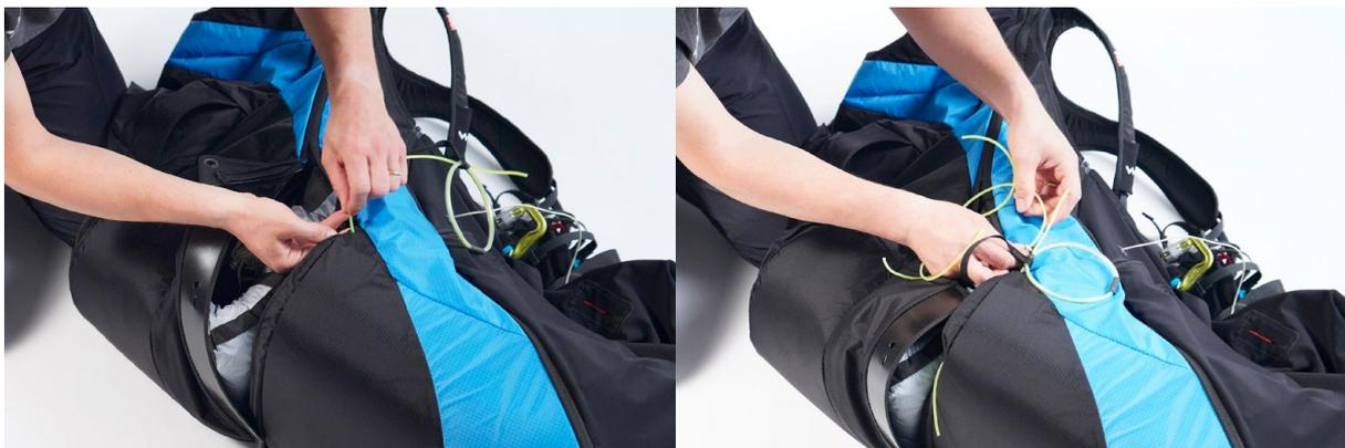
Schiebe nun das Reißverschluss Schiffchen des V-Leinen Kanal bis zu der Begrenzung im Retterfach. Verschließe den V-Leinen Kanal.
