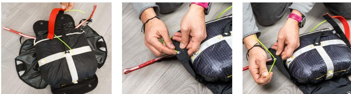
Insertar los ojales elásticos a través de los ojales de la solapa superior y luego en la inferior, fijar los pin del asa en los respectivos ojales elásticos y finalmente quitar el cordón fino. Asegurar el asa al contenedor con el velcro, de modo que mantenga la posición ideal y se evite una apertura accidental, por último insertar los dos pin en los orificios situados en la solapa inferior.
