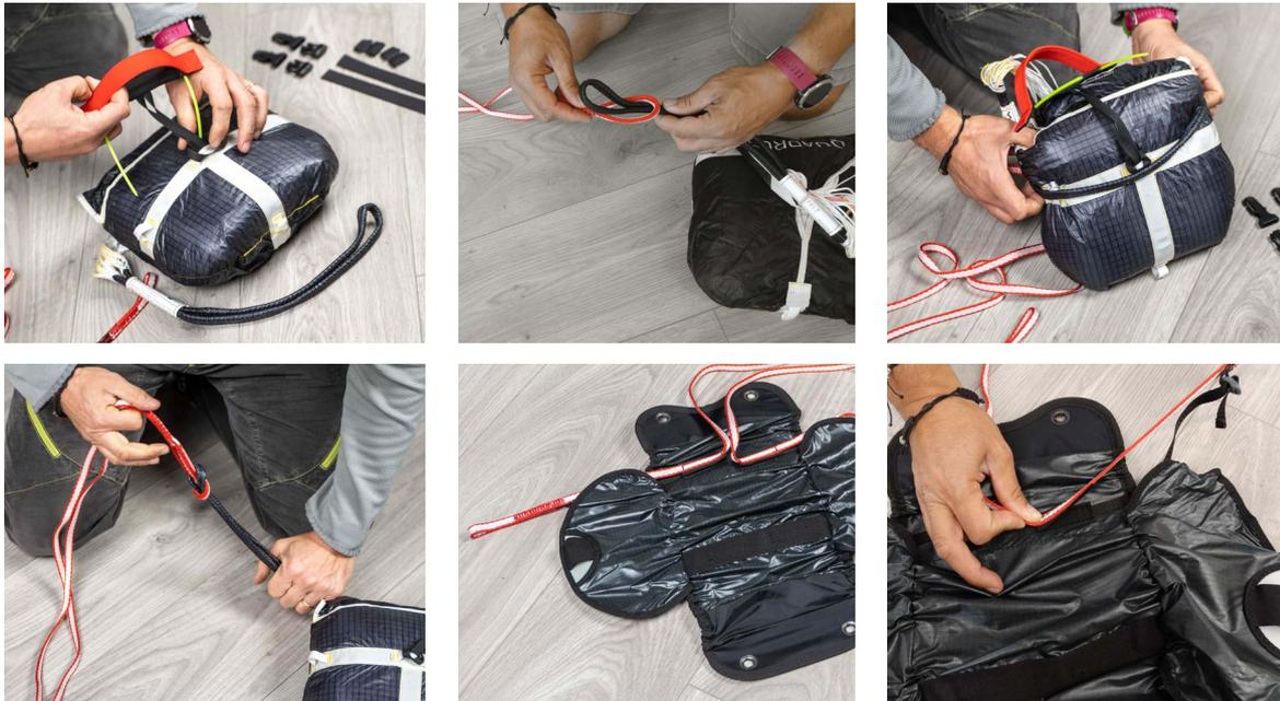
La cinta de unión del contenedor cuenta con un velcro para evitar que se pueda salir. Una vez fijados los velcros introducir el paracaídas y su haz en el contenedor manteniendo el asa girada hacia arriba. Para cerrar las solapas del contenedor ayudarse introduciendo un cordón fino (como un cordón del parapente) en cada ojal elástico, con la ayuda de los cuales lograremos cerrar el contenedor.
