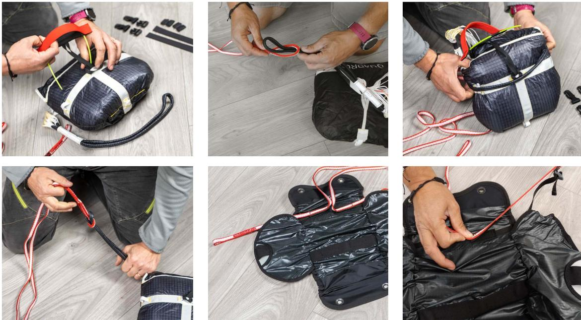
Die V-Leine des Containers ist mit einem Klettverschluss versehen, damit sie nicht herausfallen kann. Sobald die Klettbander befestigt sind, lege den Fallschirm und sein Bündel mit dem Auslösegriff nach oben in den Container. Um die Klappen des Containers zu schließen führe eine dünne Schnur (Art Gleitschirm-Leine) in jede elastische Schlaufe ein, mit deren Hilfe Sie dann den Container schließen können.
