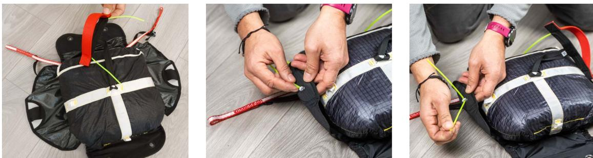
Die elastischen Schlaufen dann durch die Ösen der oberen, dann der unteren Klappe führen und die Splinte des Auslösegriffes in den zugehörigen elastischen Schlaufen fixieren. Die dünne Schnur zum Schluss entfernen. Den Auslösegriff mit den beiden Klettverschlüssen am Container sichern, sodass er seine korrekte Position beibehält und sich nicht versehentlich öffnet. Zum Schluss die beiden Splinte in die Öffnungen an der unteren Klappe einführen.
