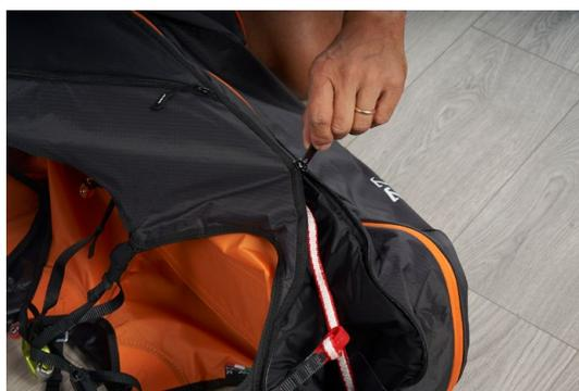
Portare il cursore della copertura della fune di vincolo e quello della seconda cerniera che chiude l'altra estremità del contenitore fino ai punti di inizio degli stessi posti sotto la maniglia del paracadute di emergenza.
