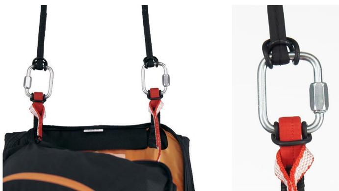
Le due connessioni vanno fatte con i moschettoni a vite con carico di rottura di almeno 1400 Kg. In ogni caso va verificato che la lunghezza della fune di vincolo sia sufficiente a posizionare l'emergenza dentro il contenitore integrato dell'imbragatura e che rimanga un lasco sufficiente a consentire l'estrazione dell'emergenza senza provocare l'apertura della sacca di lancio in fase di estrazione.
