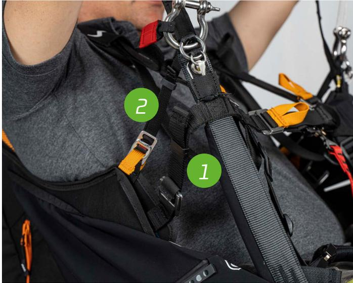
Nel dettaglio, la regolazione n°1 varia l’angolo fra le cosce e la schiena (profondità della seduta) distribuendo i carichi tra la seduta e la fascia lombare, dando così maggior comodità al pilota. La principale regolazione che permette di scegliere l’inclinazione del busto rispetto all’asse verticale di volo è la n°2, per la regolazione della schiena.
