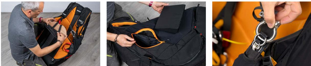
Una volta che l'imbrago si è asciugato ricordiamo di ricontrollare attentamente e lubrificare bene tutte le parti metalliche onde evitare ruggine o che si possano deteriorare.
