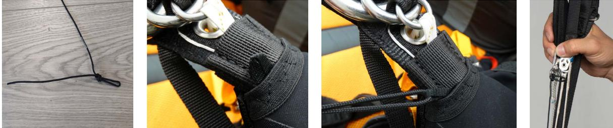
Prestate la dovuta precisione a non fissare il cordino di rilascio al loop bianco di sgancio del 3 anelli, in prossimità al loop nero.
