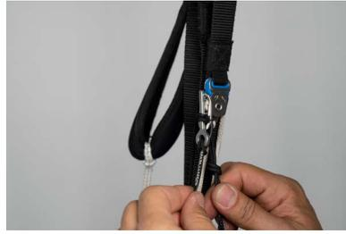
Regolare il cordino troppo corto potrebbe portare ad avere lo speed-system costantemente traziionato ed innestato non intenzionalmente durante il volo. E' più sicuro decollare con la speed-bar un po' più lunga, ed accorciarla via via negli immediati voli successivi. Si ricorda che ogni regolazione deve essere eseguita simmetricamente su entrambi i lati.
