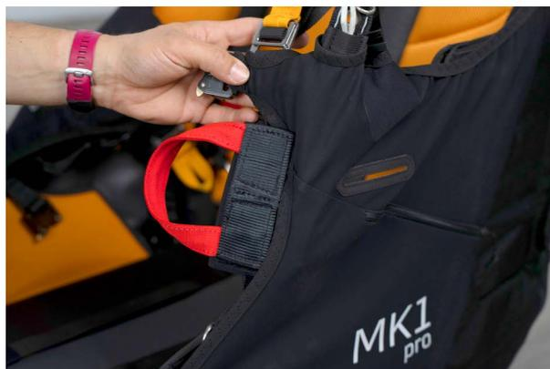
Quando viene trazionata permette il rilascio dei "3 anelli" e consente al pilota di separarsi rapidamente dalla vela del parapendio per poi aprire il BASE di riserva senza che interferisca con la vela principale.
