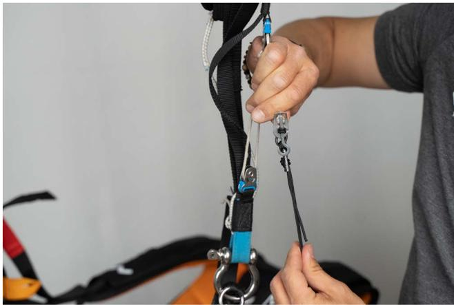
Cuando se tracciona la manija del base y se acciona el sistema de desenganche de los 3 anillos, el pin metálico del cordón de liberación recto se desliza fuera del O-Ring liberando el acelerador y desvinculando la vela.
