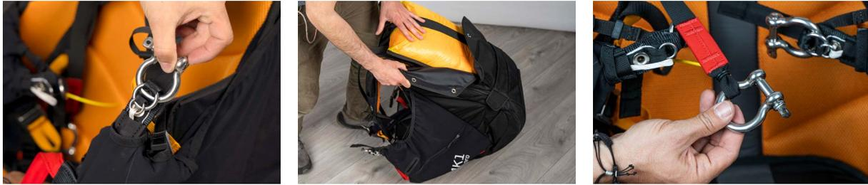
El paracaídas BASE se pliega en el *free bag* y es recolocada/almacenada en el correspondiente contenedor posterior. El contenedor del BASE se une por medio de una cinta al grillete derecho, de este modo con la liberación de los 3 anillos la *free bag* queda vinculada al parapente que tiene la función de extractor para el ala de BASE.
