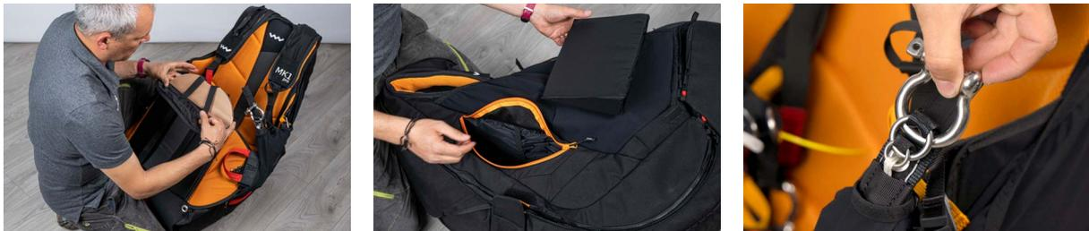
Una vez que el arnés esté seco recordamos comprobar de nuevo atentamente y lubricar bien todas las partes metálicas para evitar óxido o que se puedan deteriorar.
