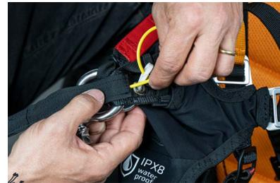
La extracción del asa del BASE provoca la liberación en cascada del sistema de tres anillos y libera rápidamente los grilletes (donde se fija la vela) del arnés, abriendo el BASE.
