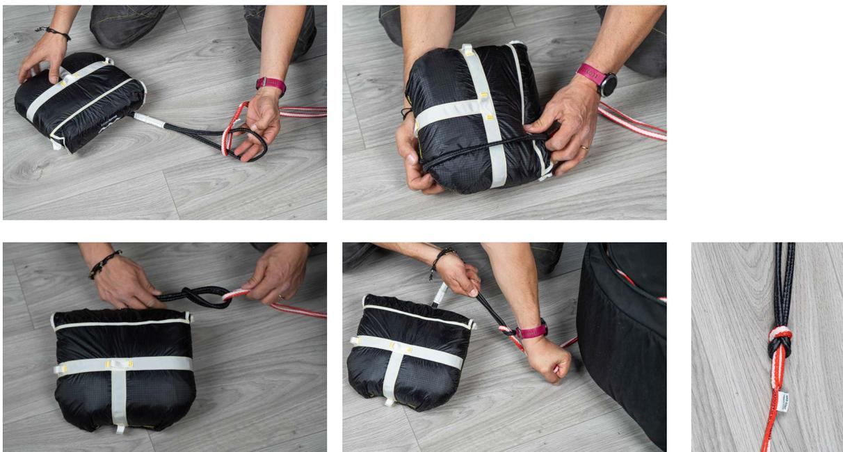
Tercer sistema: (apropiado para paracaídas pilotables o no pilotables, con cinta de unión desdoblada)
