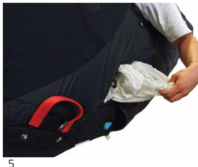
(1) Tasca laterale "Anti-G", (2) moschettone per l'aggancio della fune di vincolo del paracadute frenante (3-4). Esempio di estrazione del paracadute (5-6).
