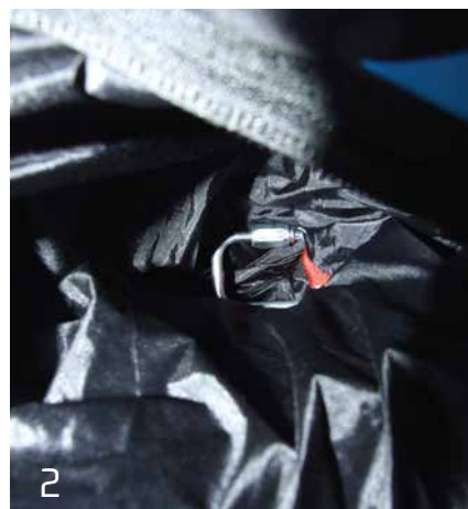
(1) Tasca laterale "Anti-G", (2) moschettone per l'aggancio della fune di vincolo del paracadute frenante (3-4). Esempio di estrazione del paracadute (5-6).
