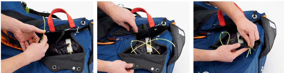
El cordón debe ser retirado al final de esta fase, debe ser removido lentamente para no dañar los ojales elásticos debido al roce excesivo entre las partes. Al final, la cremallera debe estar completamente cerrada hasta que el cursor se inserte debajo de su cubierta, detrás del tirante izquierdo.
