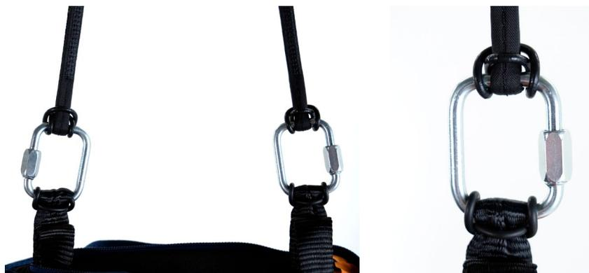
Las dos conexiones deben realizarse con mosquetones de tornillo con una carga de rotura mínima de 1400 Kg. En cualquier caso, debe comprobarse que la longitud de la cinta de sujeción sea suficiente para colocar la emergencia en el contenedor integrado del arnés y que no haya demasiada tensión para permitir que se retire la emergencia sin abrir la bolsa de lanzamiento del arnés durante la extracción.
