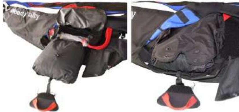
Insertar un cable fino (1 o 2 mm de diámetro) en cada bucle elástico que se utiliza para cerrar la bolsa. Utilizando los cables, tire de los ganchos elásticos a través de los ojales, elegir aquellos que mejor se adapten al tamaño de su paracaídas de emergencia. Siga el orden de cerrar los diversos flaps como se muestra en las fotos a continuación.
