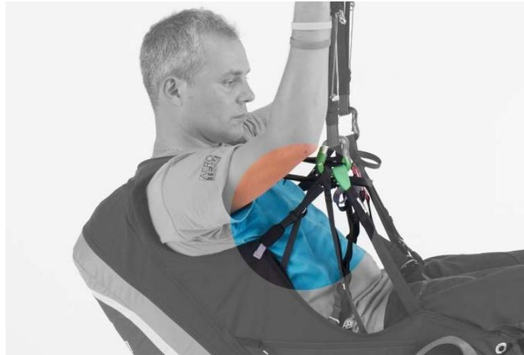
En esta imagen se aprecia cómo funciona el ajuste de la espalda distribuyendo la carga en dos puntos a cada lado, para mejorar el confort. Este ajuste permite elegir la inclinación del busto con respecto al eje de vuelo vertical.
