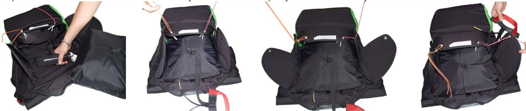
Inserte un cordón delgado (tipo línea de parapente) en cada ojal elástico, con la ayuda del cual podrá cerrar el contenedor. Inserte los ojales elásticos en los ojales más pequeños con respecto a los otros ojales de las solapas del contenedor. Siga el orden de cierre de las distintas solapas visibles en los dibujos/fotografías siguientes.
