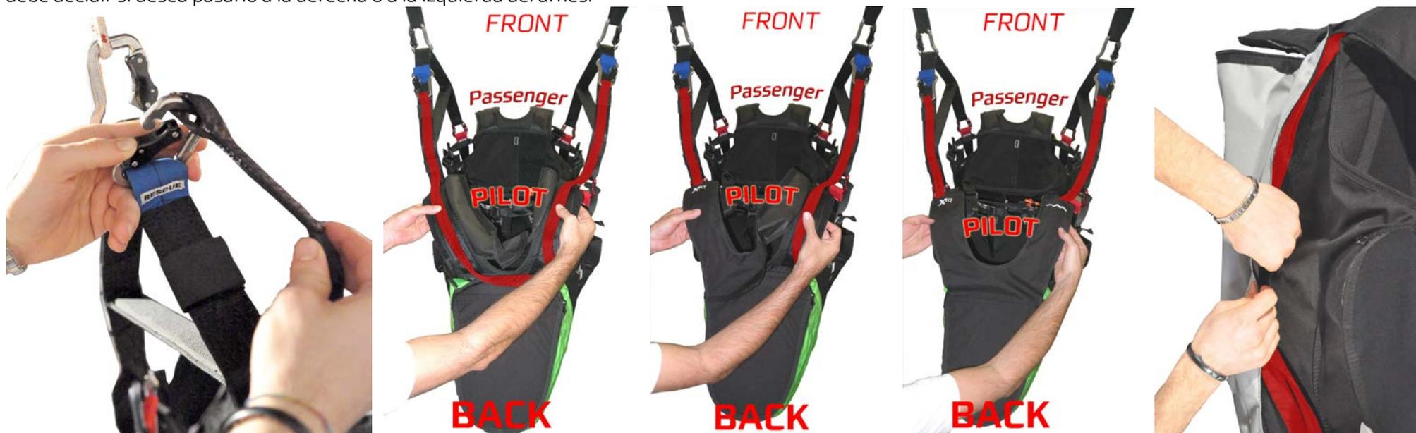
En cualquier caso, debe comprobarse que la longitud de la cinta de sujeción sea suficiente para colocar la emergencia en el contenedor integrado del arnés y que no haya demasiada tensión para permitir que se retire la emergencia sin abrir la bolsa de lanzamiento durante la extracción.
