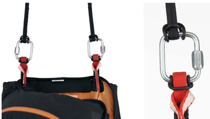
Las dos conexiones deben realizarse con mosquetones de tornillo con una carga de rotura mínima de 1400 Kg. En cualquier caso, debe comprobarse que la longitud del cable de sujeción sea suficiente para colocar la emergencia en el contenedor integrado del arnés y que no haya demasiada tensión para permitir que se retire la emergencia sin abrir la bolsa de lanzamiento del arnés durante la extracción.
