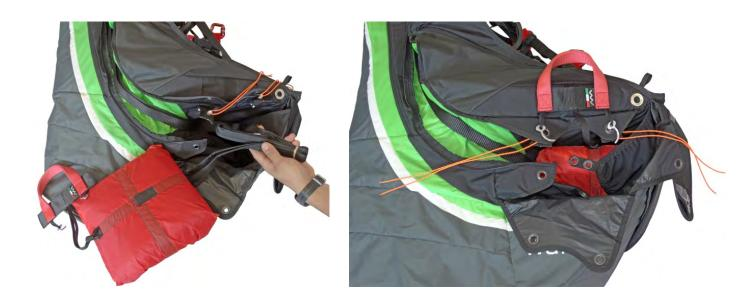
Um die Größe des Containers den Abmessungen des Fallschirms anzupassen, verwende die Laschen an den Enden des dehnbaren Stoffes: verwende bei kleinen Fallschirmen die näher beim Fallschirm liegenden Lasche, bei großen Fallschirmen die andere Lasche. Die beiden Enden des dehnbaren Stoffes zum Verschließen überkreuzen, so dass der Fallschirm so gut wie möglich am Sitzbrett anliegt.
