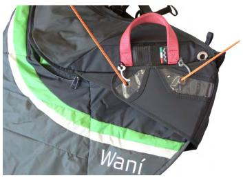
Nach dem Schließen aller Teile des Containers überprüfe, dass der Reißverschluss unter dem Öffnungssystem korrekt geschlossen ist. Die Schnur muss am Ende dieser Phase vollständig entfernt werden. Ziehe sie dazu langsam heraus, um die elastischen Schlaufen nicht durch übermäßige Reibung zwischen den Teilen zu beschädigen.
