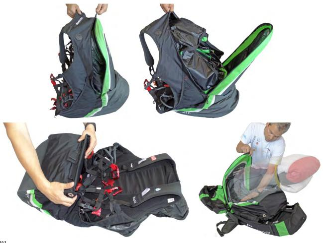
Den Teil der hinteren Tasche und schließlich den Verschluss des Rucksacks über den Gleitschirm ziehen. Um den Reißverschluss problemlos zu schließen drücke den Rucksack zusammen, damit die im Gleitschirm und Airbag verbleibende Luft austritt.
