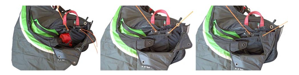
Bewege das Schiffchen des Reißverschlusses der Abdeckung der Verbindungsleine ganz nach rechts, und schließen Sie dann den Reißverschluss, indem Sie das Schiffchen etwa 20 cm nach links schieben. Beginne dann mit dem Schließen der Außenteile des Containers in der abgebildeten Reihenfolge; gib dabei Acht, dass sich der Reißverschluss nicht von rechts wieder öffnet. Schiebe die Splinte des Griffs in die elastischen Schlaufen und unter die transparente Abdeckung.
