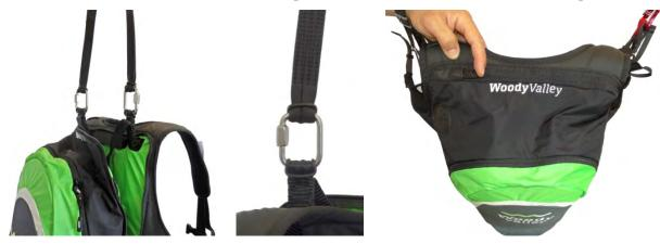
Für diese Verbindung benötigt man zwei Schraubkarabiner mit einer Bruchlast von mindestens 1400 kg. Es muss sichergestellt werden, dass die Länge der Verbindungsleine ausreicht, um das Rettungsgerät in den dafür vorgesehenen Rettungsgeräte-Container des Gurtzeugs einzufügen. Es muss genügend Leinenlänge vorhanden sein, um sicherzustellen, dass bei der Betätigung des Rettungsfallschirms der Rettungsschirm noch im Rettungsschirm-Container bleibt, bis er geworfen wird.
