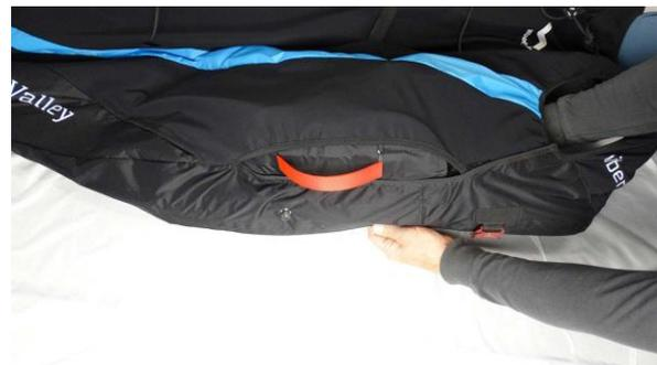
Die Schnur muss am Ende dieser Phase vollständig entfernt und dazu langsam herausgezogen werden, um die elastischen Schlaufen nicht durch übermäßige Reibung zwischen den Teilen zu beschädigen.
