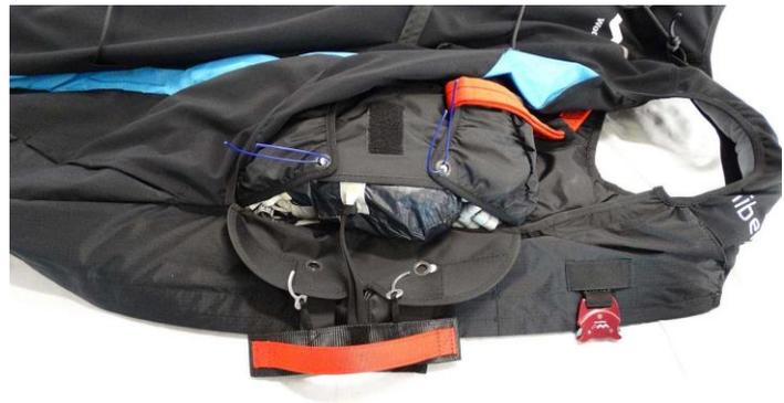
Führen Sie eine dünne Schnur (1 bis 2 mm Durchmesser) in jede elastische Schlaufe ein, mit deren Hilfe Sie dann den Container schließen können. Führen Sie die elastischen Schlaufen in die beiden kleinsten Ösen ein. Befolgen Sie die Abfolge zum Schließen des Rettungscontainers (wie auf den Fotos dargestellt). Die Metallstecker des Griffs in die elastischen Schlaufen einführen.
