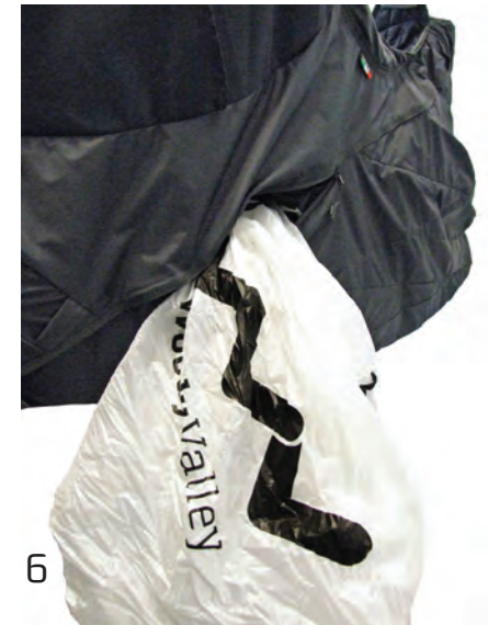
(1) Seitentasche "Anti-G", (2) Karabiner zum Einhaken der Verbindungsleine des Bremsfallschirms (3-4). Beispiel des Herausziehens des Fallschirms (5-6).
