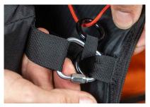
Para instalar los softlinks, siga el procedimiento que se muestra en las siguientes imágenes. Coloque primero el softlink en el bucle delantero del arnés, detrás de los dos anillos sujetos con el elástico, y después en el bucle de protección. Coloque el bucle del softlink en el bucle bajo la pieza de plástico y a continuación fíjelo introduciendo la pieza de plástico a través del propio bucle. Por último, gire el softlink para colocar la pieza de plástico bajo el bucle del arnés.
